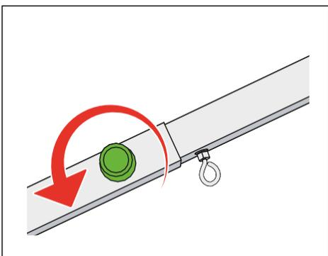
2 Desserrer la vis moletée de la tige de poussée télescopique.
