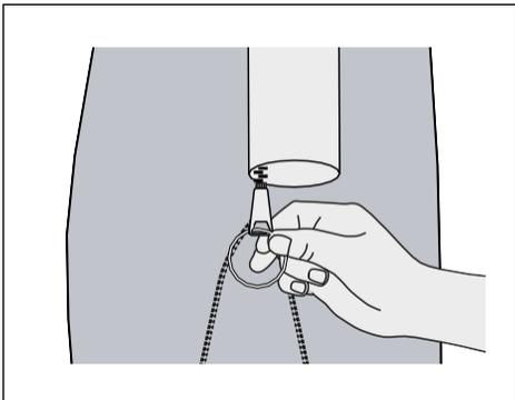
1 Attachez l'anneau porte-clés à la fermeture éclair de la housse de protection.
