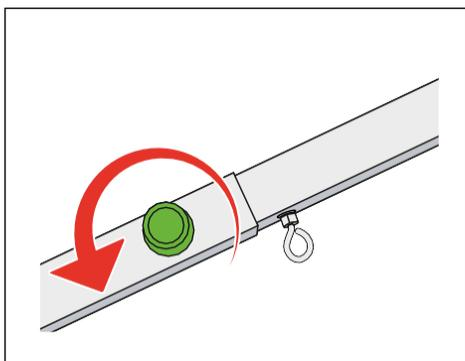
2 Die Rändelschraube an der Teleskopschubstange öffnen.
