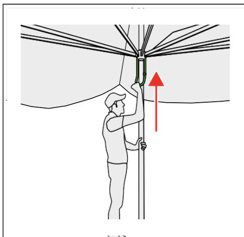
6 Den Hebel mit Schwung nach oben drücken, bis der Verschlusseinrastet.
