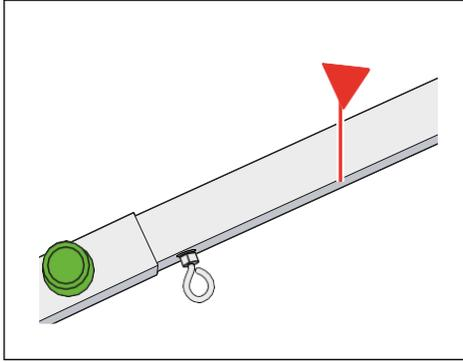
3 Die Teleskopschubstange auf erforderliche Länge aufziehen.
