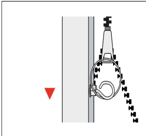
8 Die Ringschraube der Teleskopschubstange in den Schlüsselring am Reißverschluss der Schutzhülle lösen.
