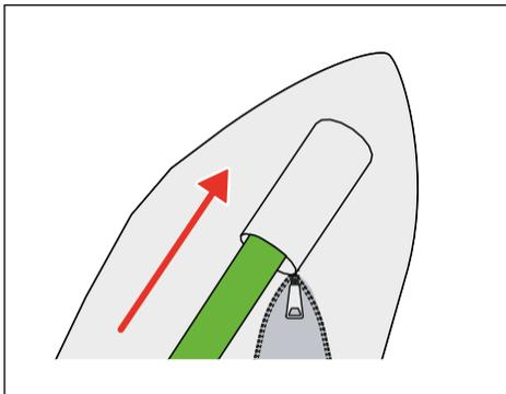
5 Teleskopschubstange in die Tasche der Schutzhülle stecken.
