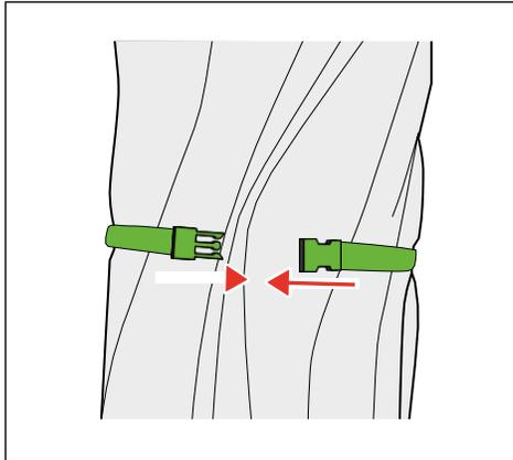
6 Das geschlossene Schirmdach mit dem Gurt sichern.
