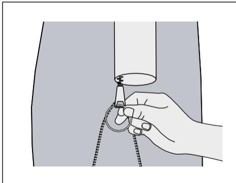
1 Den Schlüsselring am Reißverschluss der Schutzhülle befestigen.
