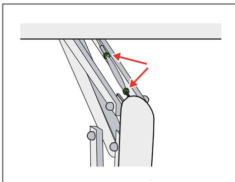
► Les contre-écrous sur le tendeur sont desserrés.
