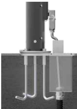
Länge 35 cm. Die Standardlösung für normale Betonfundamente. Die Größe des Fundaments sollte mindestens 80 x 80 x 80 cm betragen.
